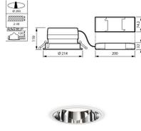
Technische Daten Philips LED Downlight LuxSpace Kompakt tief DN571B 19.8W 2200lm 75D - 840 | 214mm - Aluminium Reflektor - 3 Stunden Notbeleuchtung
