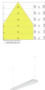
**Technische Daten Ledvance LED Linear Pendelleuchte IndiviLED 42W 4650lm - 830 | 120x12cm - Dali Dimmbar - Direct/Indirect**
